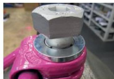
Obr. 10 – Pojistný kroužek
