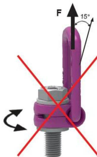
Obr. 7 - zakázaný směr otáčení při zvedání břemene ve směru osy šroubu ( $+15^\circ$ ).
