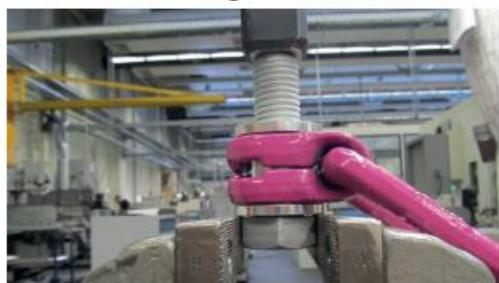
Obr. 8 - Demontážní pozice pro VLBG-PLUS
