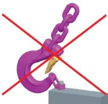
Obr. 2 – Používejte pouze vhodné zvedací komponenty určené pro zavěšení nebo k zaháknuté do VLBG-PLUS vázacího bodu.
