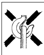
Fig 2 c Krokspärren blockerad!
