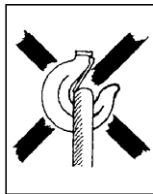
Fig. 2 c Kroksperrern blokkert!
