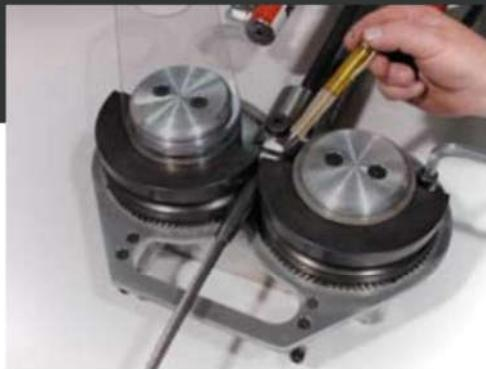
1 Vyberte pár válečkových matric, které korreaguje na průměr kabelu a nasuňte je na synchronizační kolíky ozubeného kola. Šipky na matricích by měly být vždy ve směru pěchování.
