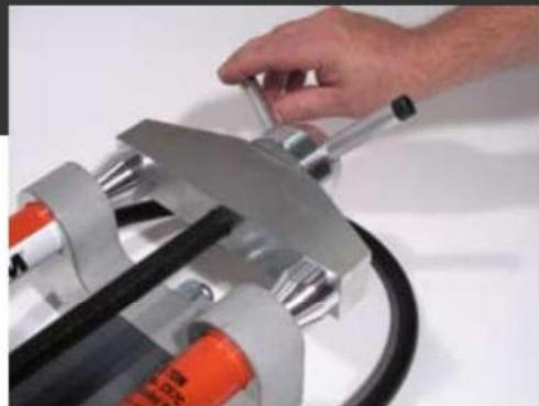
2 Připojte koncovku kupevňovacímu přípravku na oji a upravte délku tak, aby se válečkové matrice dotýkaly stopky koncovky podle potřeby pozice.
