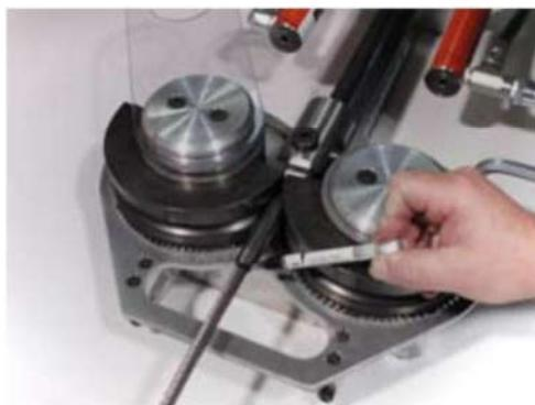
3 Použijte dostatečný hydraulický tlak, aby válečkové matrice pevně drží terminál. Poté označte a vložte kabel do spodní části hrdla svorky.
