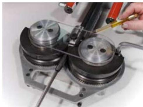
4 Zasuňte průhledný ochranný štít dovnitř pozice. Aplikujte hydraulický tlak, abyste natáhli koncovku mezi válečkové matrice.
